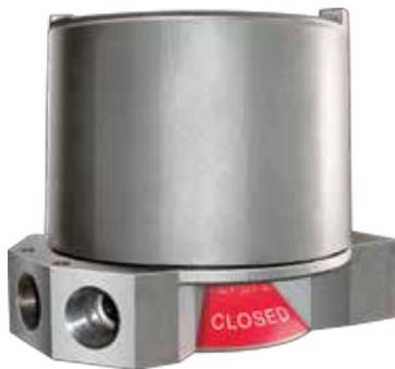
کنترلر شیر مدل VSD CF8M استنلس استیل تصدیق شده با گواهی های ATEX / IECEx Dual Certified Ex d بخش اطلاعاتی شیر را جهت خاموش کردن اضطراری آن ادغام کرده است، (بصورت ادغام نظارت و کنترل وضعیت شیر و تست عملکرد حرکت کامل (FST) و حرکت بخشی شیر (PST) VSD یک مرکز اطلاعات برای شیر ESD می باشد که کاربر را قادر میسازد تا امکان وجود حساس ترین شیرها در کارخانه را بدون نیاز به تغییر محسوس در روش عملکرد شیر بررسی کنند.
